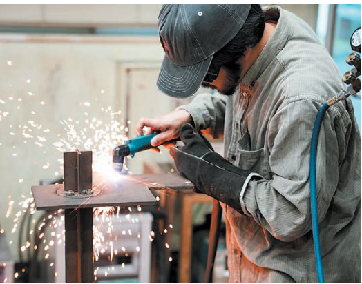
鉄板を切断している様子
