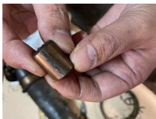
⑧ローラーベアリングの転動体の摩耗
