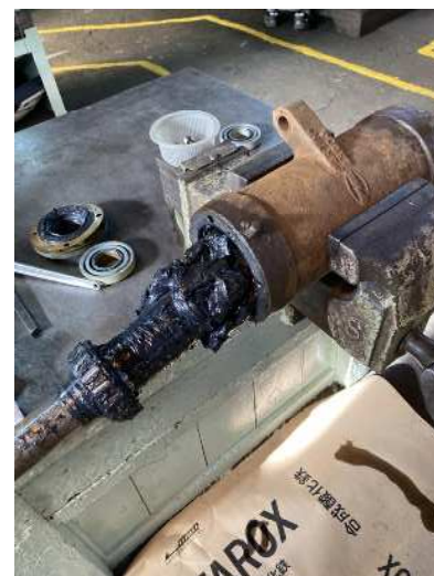
③正常な場合のグリスの状態
