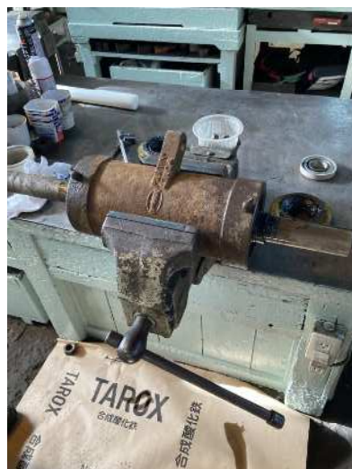
②①の写真の赤丸箇所にあるベアリングボックス
