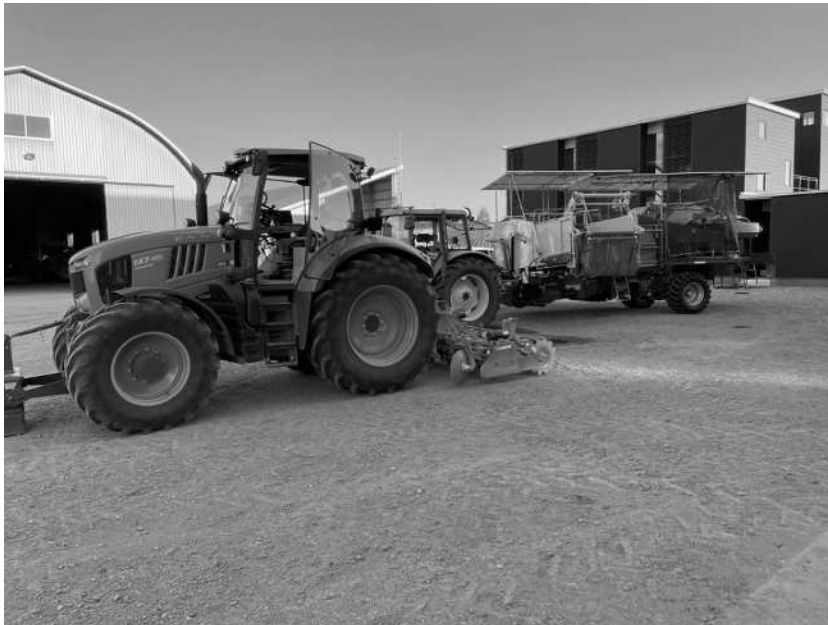
GNSS を利用した自動運転が可能な大型トラクター
