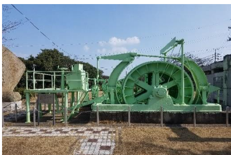
⑨単胴コース巻上機 山陽無煙鉱業所(美祢市)の斜坑で炭車等を巻き上げるために使用されたもの
