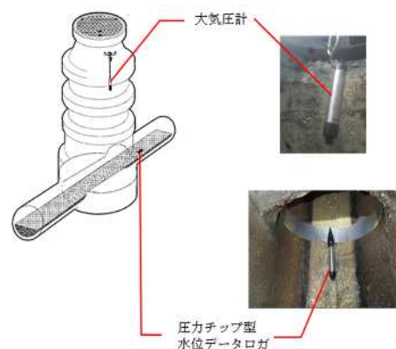
図1 水位・温度センサ設置図(参考)
