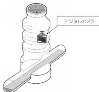
図2 デジタルカメラ設置の概要図
