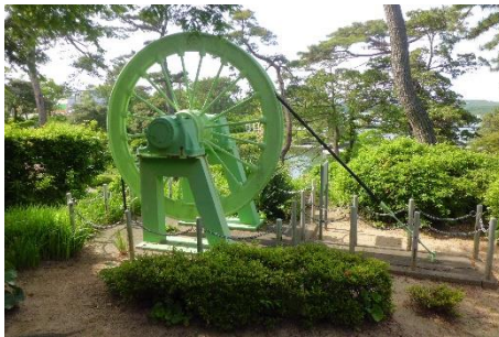
①矢弦車(ヘッドシーブ) 現在、石炭記念館展望台となっている東見初電車竖坑櫓の上部にあった2車のうちの1車
