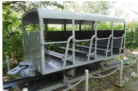
③人車 山陽無煙鉱業所(美祢市)の水平坑道で使用された人員運搬用の車両
