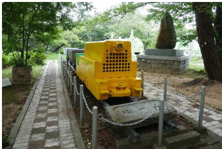
④坑内石炭運搬車 山陽無煙鉱業所(美祢市)の水平坑道で使用されたディーゼル機関車で石炭等を積んだ炭車を20両つないで運搬した。
