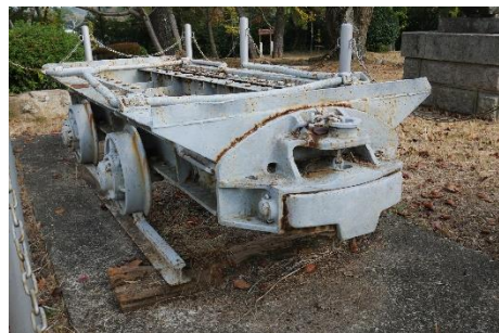
⑫鉄製台車 坑杵、レールなどの材料を運ぶためのもの
