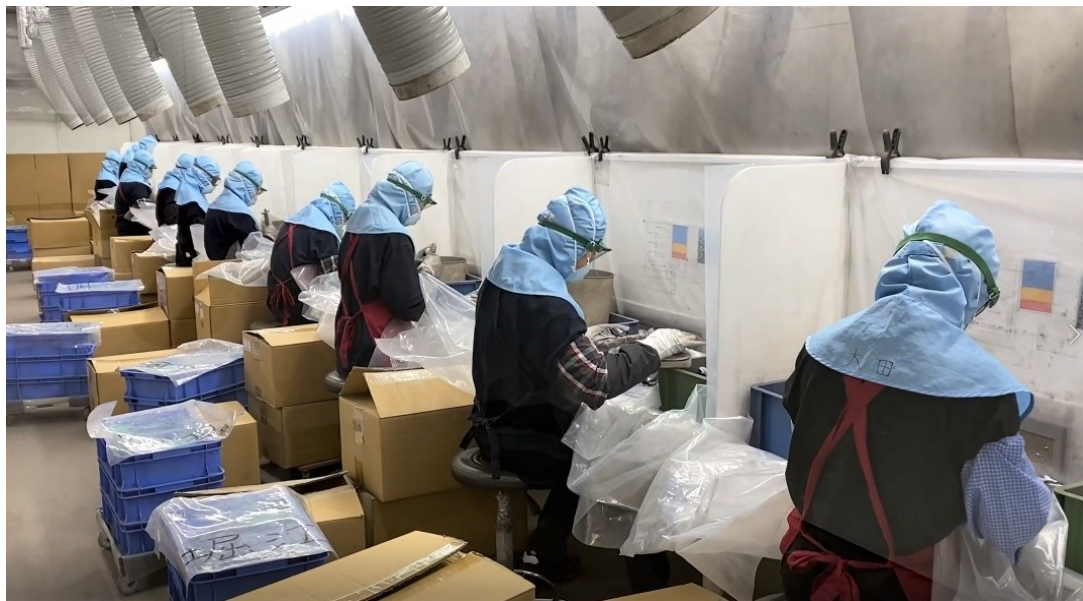
半導体部門のポリシリコン破碎工程
