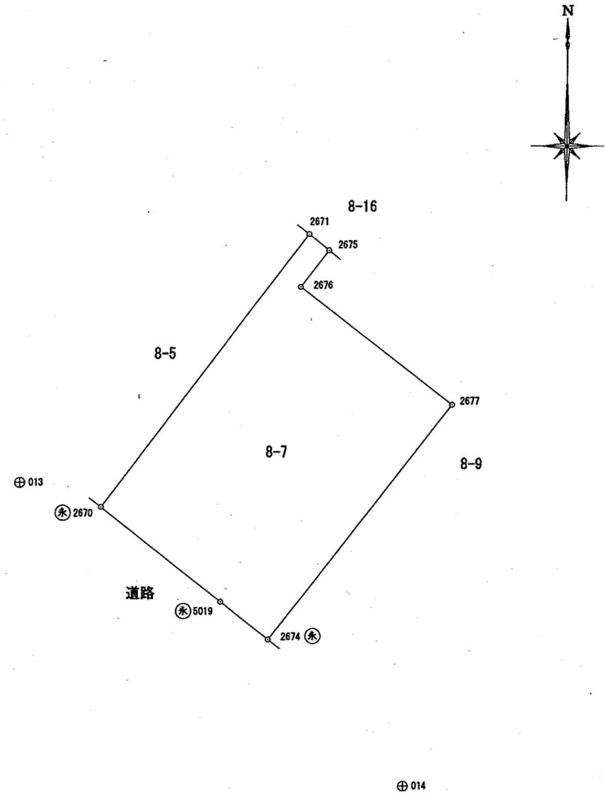
この測量図は、登記所備付地図作成作業に伴い作成したものであり、同作業により設置された基準点及びその与点を基に測量した成果による。
