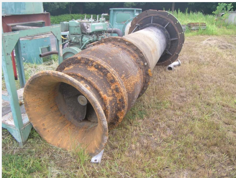
雨水ポンプの劣化状況（H29更新）
