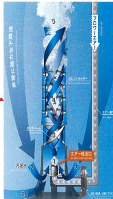
【図2】エアレーター(炭酸ガスによる混合攪拌)
