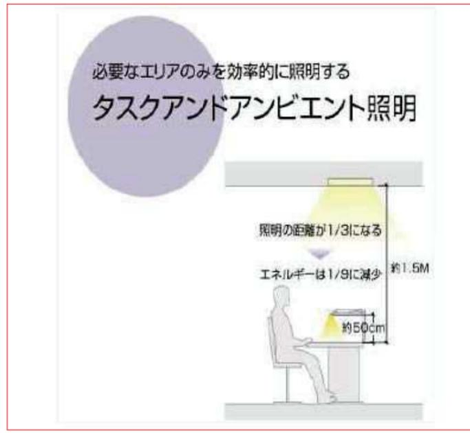
全般照明(高効率蛍光灯)方式に比べ、イニシャルコストは30%増加、電力消費量70%削減、ランニングコストは67%削減可能。3年目から全般照明(LED)方式より、LCC(イニシャルとランニングコスト)が安くなる。
